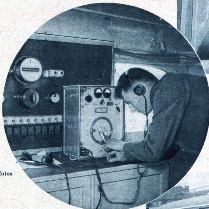
Zu einer Säule vereinigt fichen die einzelnen Verstärkerstufen im rückwärtigen Teil des Regiewagens. Dahinter ein Mikrophult.
